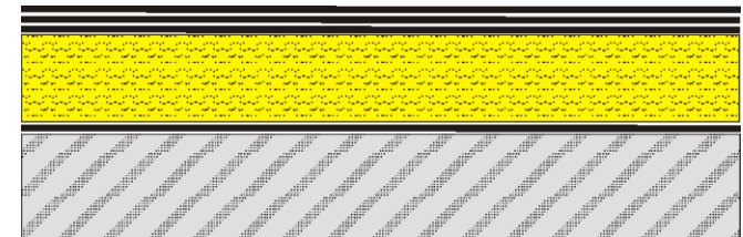
Sistema com manta asfáltica
