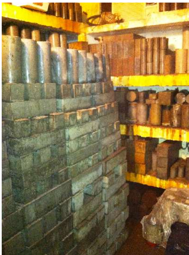
Figura 1: Corpos de prova na câmara úmida
