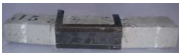
Figura 28: Face Inferior da Viga J5 após Ruptura
