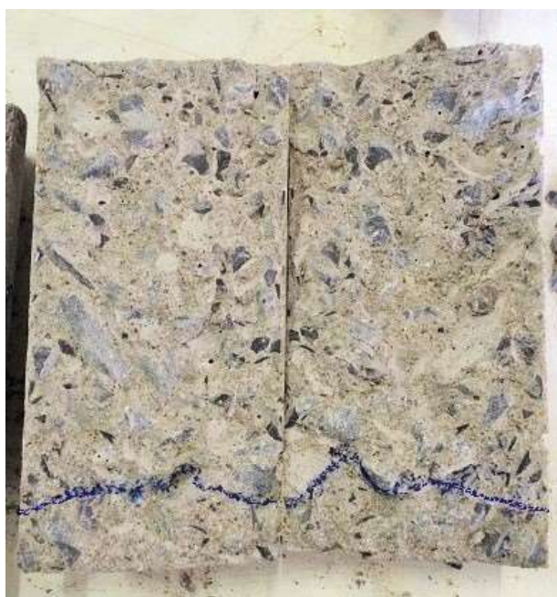
Figura 7: Penetração de água no CP de 20 MPa
