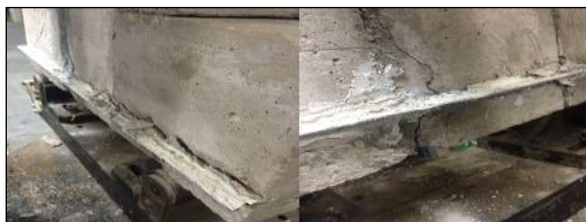
Figura 10: Rompimento do segundo modelo reforçado
