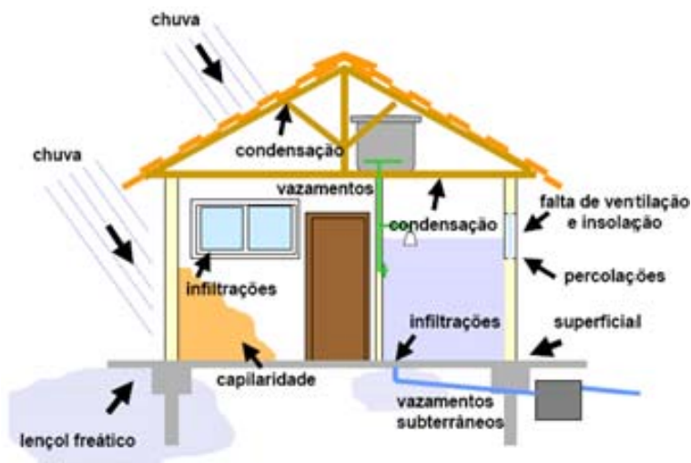
Figure 1. Ação da umidade sobre edificações.
