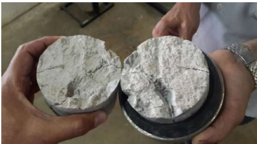
Figura 16 - Rompimento de testemunho.
