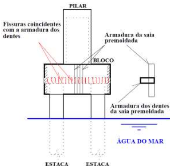
Figura 7: Bloco sobre estacas com desprendimento do cobrimento do concreto
