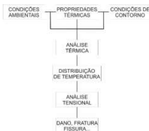
Figura 1: Representação global do método desacoplado de resolução das tensões térmicas (adaptada de Calmon [2])
