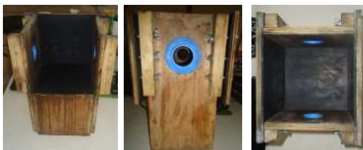
Figura 7 – Protótipo para leituras com ultrassom no concreto fresco.
