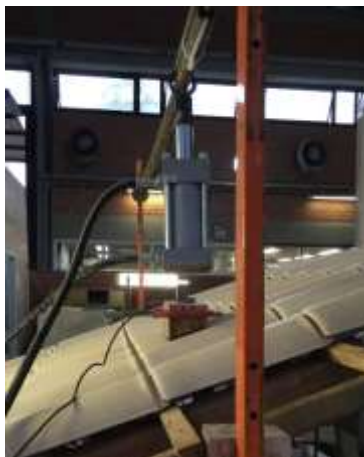
Figura 4 – Ensaio de resistência ao caminhamento em cobertura de telha cerâmica.
