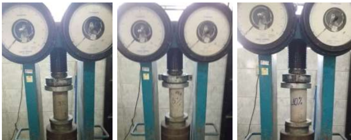
Figura 4: Momento do ensaio de compressão axial dos corpos de prova com diferentes adições. (Fonte: Própria, 2015.)
