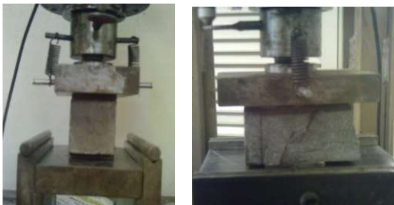
Figura 29: Ensaio de resistência à compressão axial.
