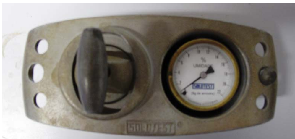
Figura 6: Speedy Test para verificação da umidade da areia
