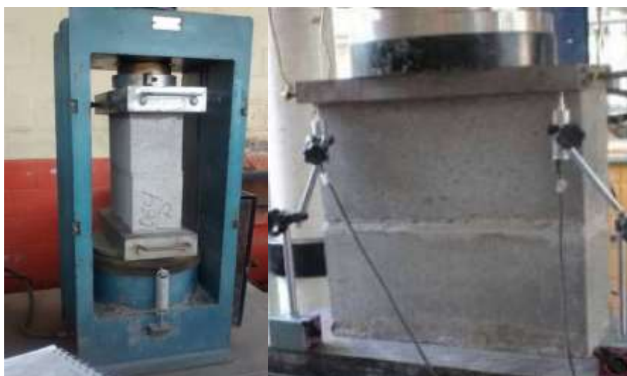
Figura 12 – Ensaio de Resistência do concreto e do prisma.
