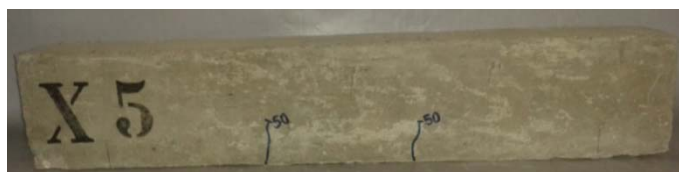
Figura 9 – Viga X5 pré-fissurada.
