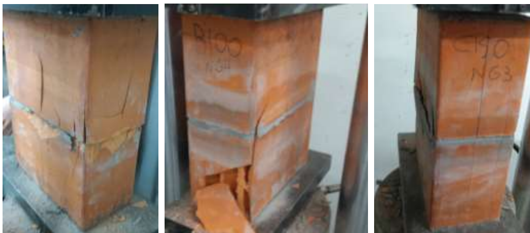
Figura 5: Ruptura de prismas. (a) Argamassa A50. (b) Argamassa B100. (c) Argamassa C150
