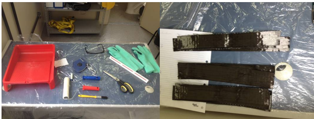
Figuras 9 e 10 : Materiais utilizados para preparação da manta de fibra de carbono (Figura 9) e manta de fibras de carbono após preparação (Figura 10)
