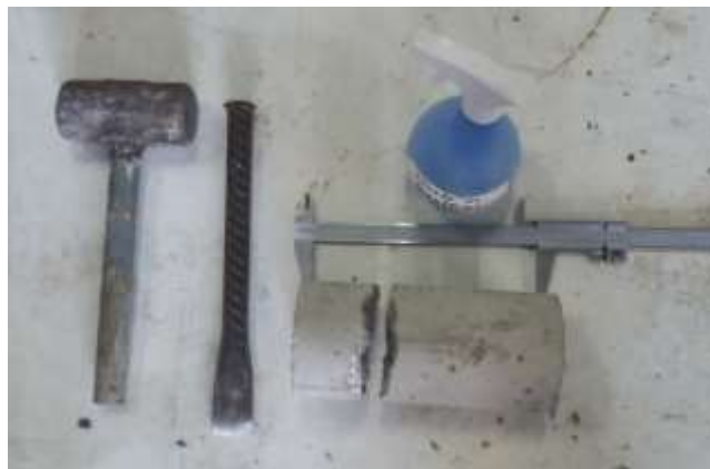
Figura 4: Instrumentos necessários para a execução do ensaio de carbonatação.
