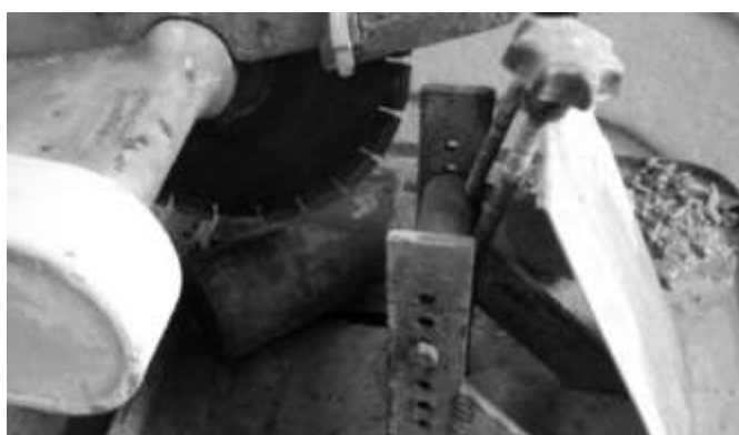
Figura 3 - Execução de corte a 45°
