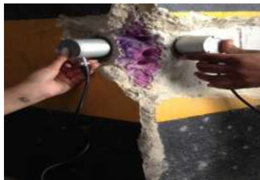
Figura 7 – Ensaio de ultrassom com transmissão indireta
