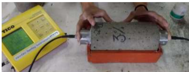
Figura 5: Realização do ensaio de ultrassom. (Fonte: Própria, 2015.)
