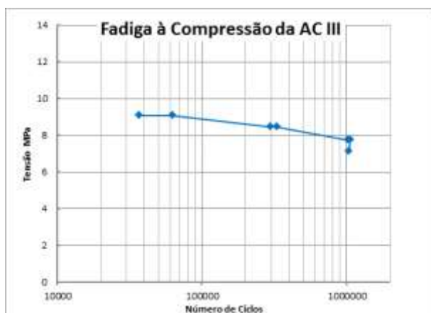
Figura 39: Curva S-N da fadiga à compressão da ACIII.
