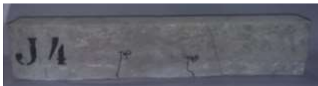
Figura 20: Viga J4 após Pré-Fissuração
