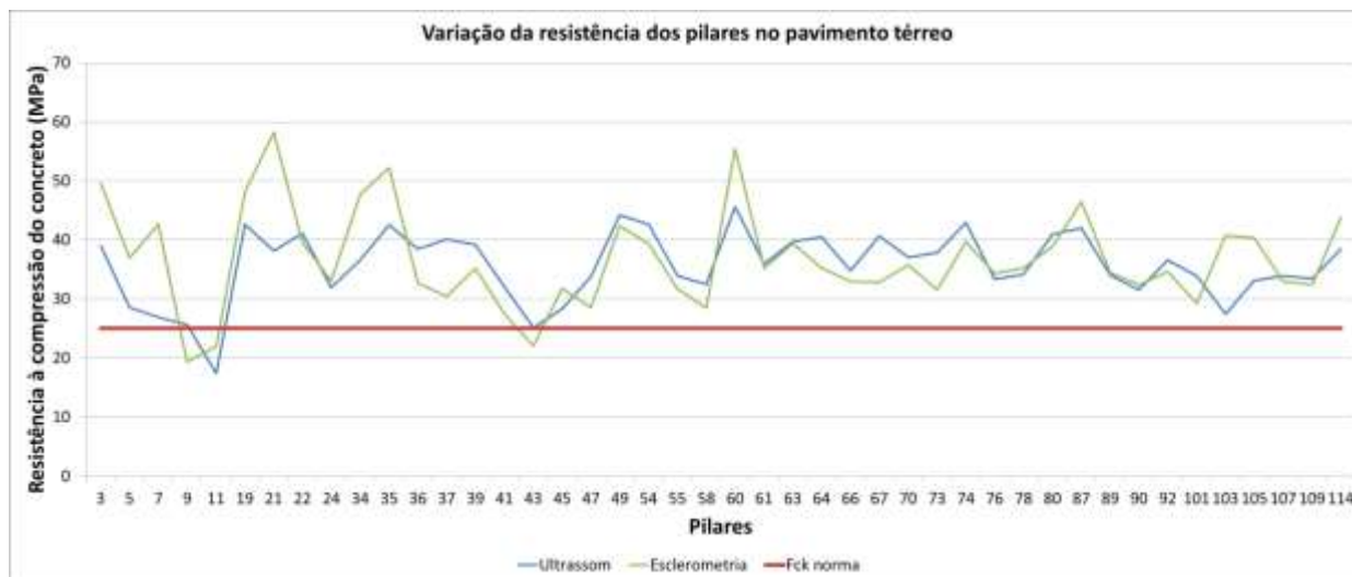
Figura 4: Variação e análise da conformidade da resistência à compressão do concreto segundo os ensaios de ultrassom e esclerometria, para os pilares do pavimento térreo.
