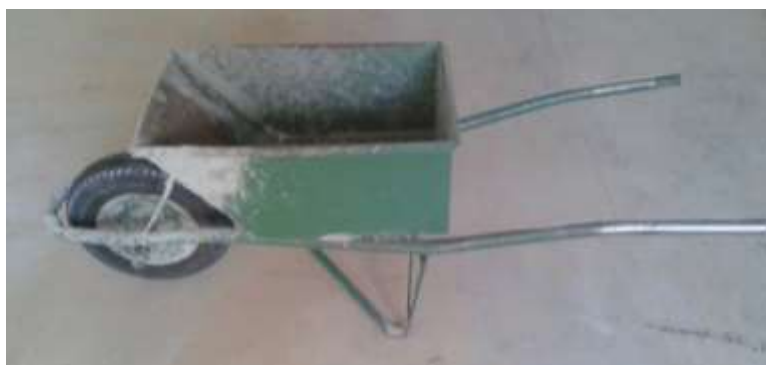
Figura 7 – Carrinho jericas utilizado para transporte da argamassa.
