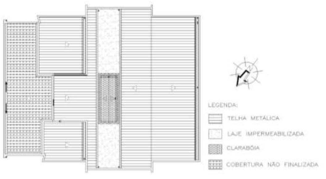
Figura 2: Planta da cobertura com identificação do trecho não finalizado.
