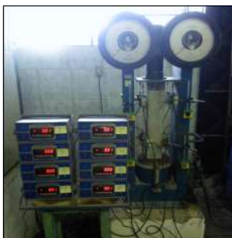
Figura 1: Prensa adaptada ao ensaio de compressão com os LVDT's
