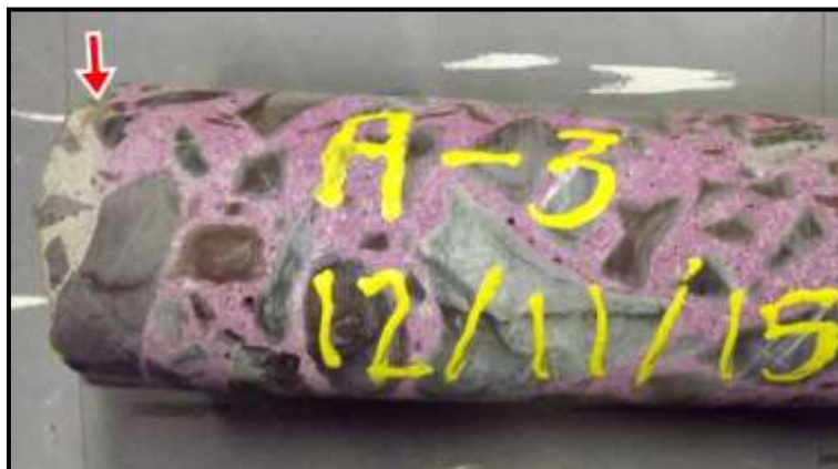
Figura 7: Forma como o corpo de prova se apresenta após ser submetido à solução de fenolftaleína. A seta indica a região carbonatada, que manteve sua cor original
