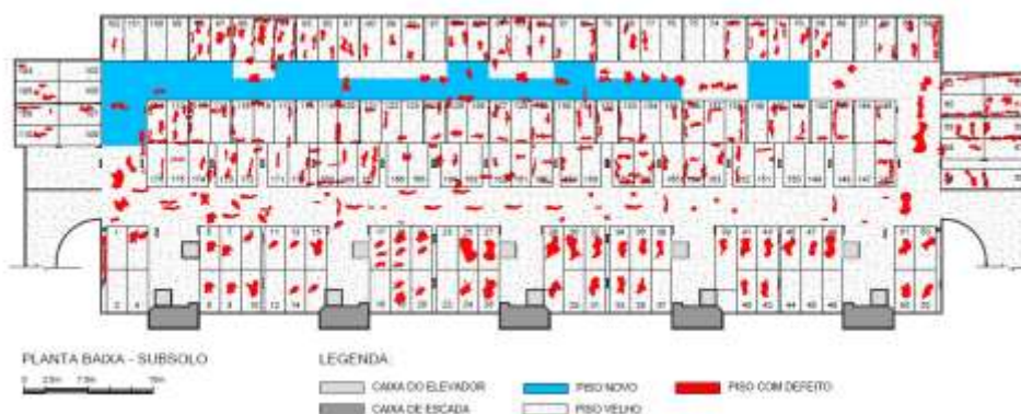
Figura 10 – Croqui que detalha todos os pontos que apresentaram som cavo.
