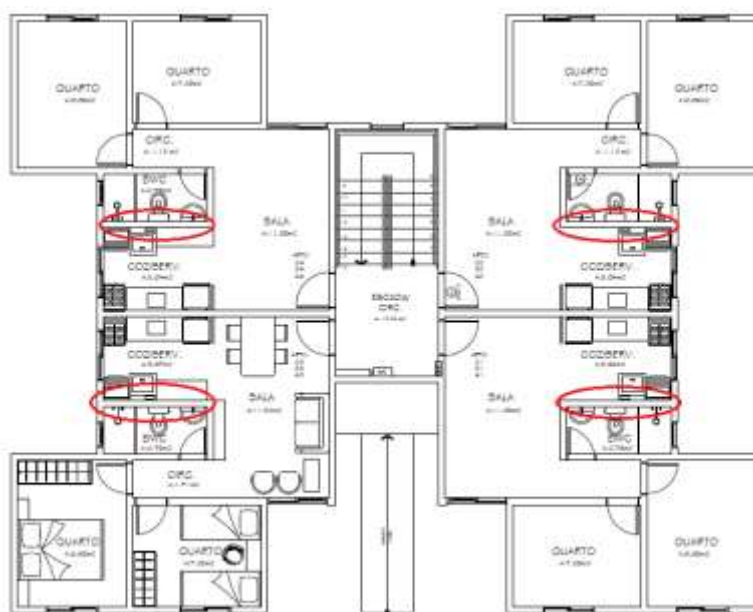
Figura 6: Planta baixa pavimento tipo – “Parede crítica 2”
