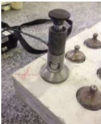
Figura 4: Ensaio de resistência de aderência à tração – Fonte: dos autores
