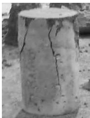
Figura 7 - Rompimento total do corpo de prova
