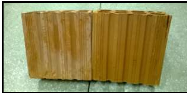
Figura 8: Mudança visível do bloco cerâmico submetido ao NaCl em relação ao bloco de referência
