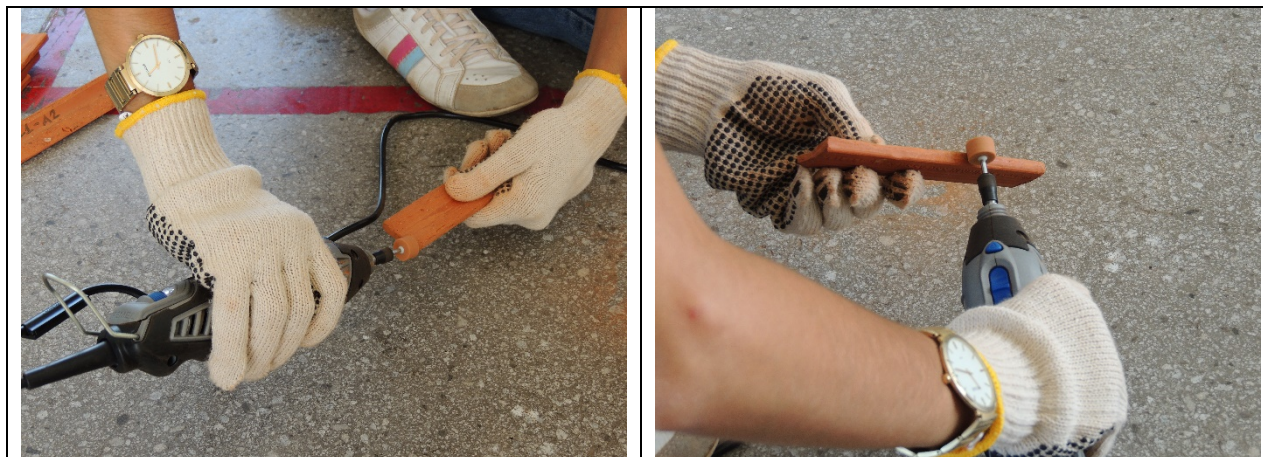
Figura 1: Preparação das amostras para avaliação do módulo de elasticidade dinâmico.
