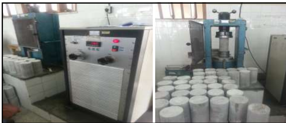
Figura 8: Prensa Hidráulica e ensaio de compressão do concreto.
