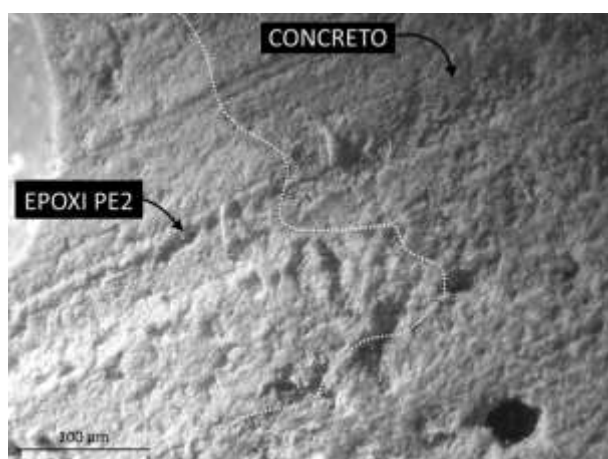
Figura 11 - Contato Resina PE2 e concreto
