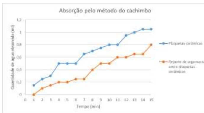
Figura 4: Permeabilidade do revestimento cerâmico
