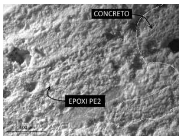
Figura 12 - Contato Resina PE2 e concreto
