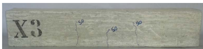
Figura 7 – Viga X3 pré-fissurada.
