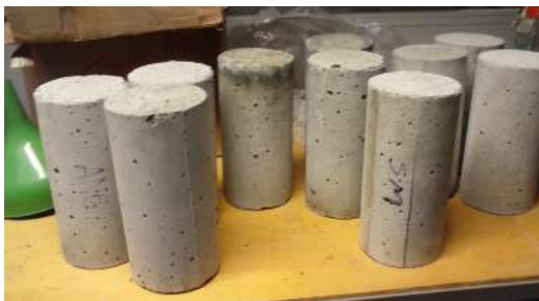
Figura 1 - Corpos-de-prova utilizados na realização do ensaio. Fonte: autora
