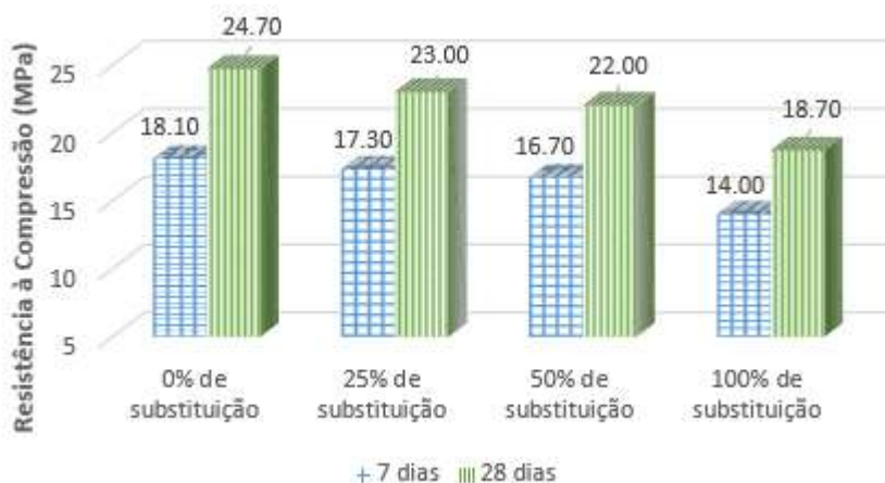
Figura 3: Evolução da Resistência à Compressão com relação aos teores de substituição de agregado miúdo de RCD
