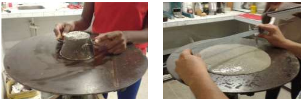
Figura 6 - Determinação do índice de consistência.
