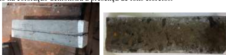
Figura 3: Sulco no centro da amostra e amostra de concreto após rompimento e aspersão do nitrato de prata
