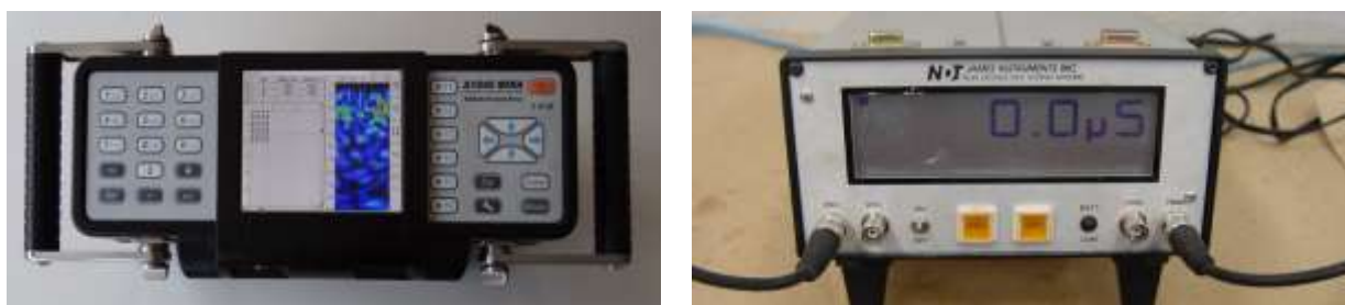
Figura 1: (a) Tomógrafo 3D e (b) Equipamento de VPU.
