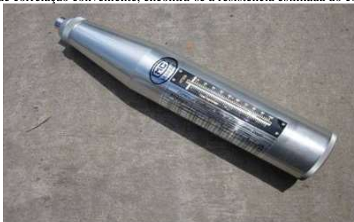
Figura 1: Esclerômetro similar ao utilizado no ensaio
