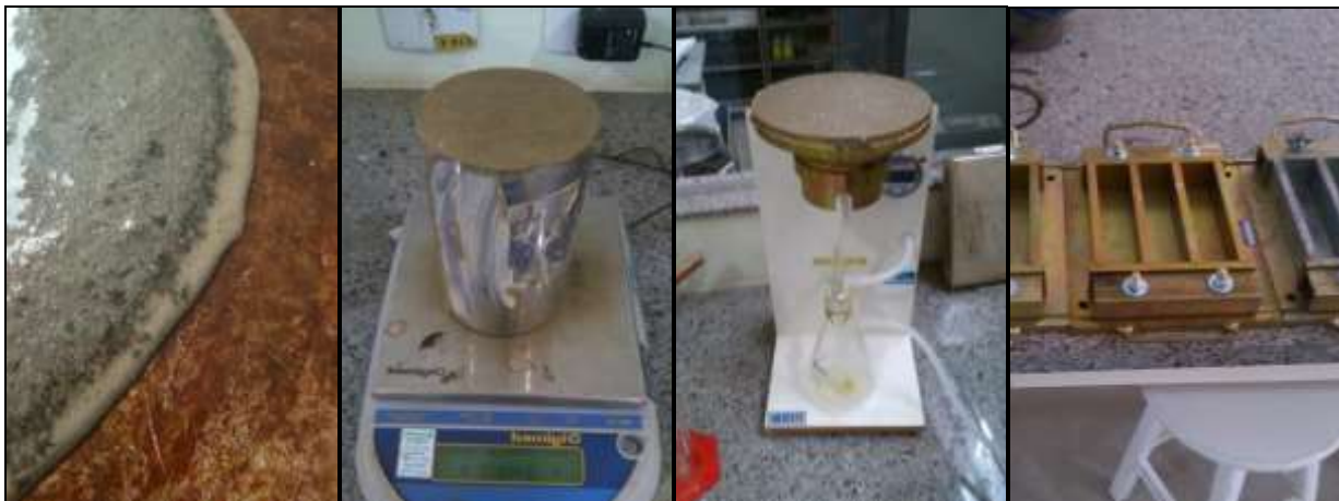
Figura 13: Ensaios das argamassas no estado fresco e moldagem dos corpos de prova.
