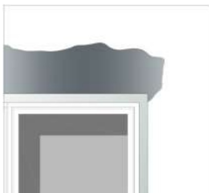
Figura 11: Configuração típica de infiltração na interface janela/verga
