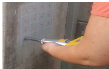
Figura 8: Impacto com o esclerômetro.
