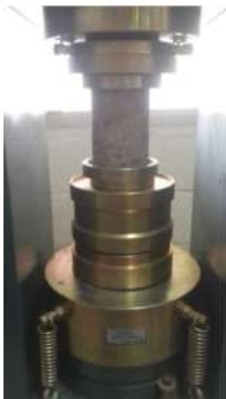
Figura 14 - Rompimento dos testemunhos com a utilização da prensa hidráulica.
