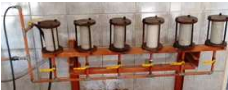
Figura 6: Ensaio de penetração de água sob pressão.
