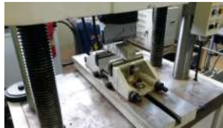
Figura 07 – Ensaio de tração na flexão
