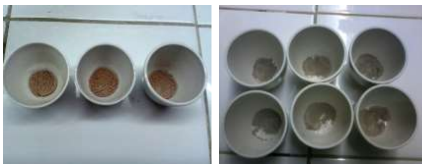
Figura 8: À esquerda amostras do pó de Cedrela odorata ; à direita fragmentos de cada série de concreto. (Fonte: Própria, 2015).
