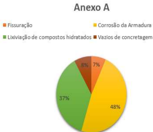
Figura 5 - Gráfico 1: Incidência total de patologia no anexo A por elemento estrutural
