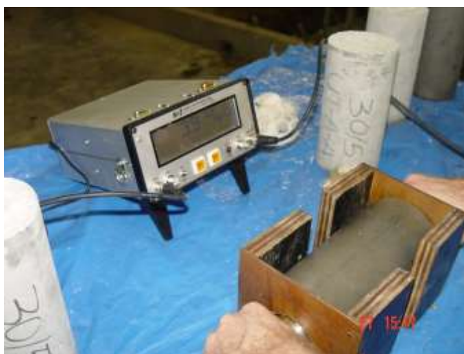
Figura 1: Ensaio Ultrassônico no Concreto.
