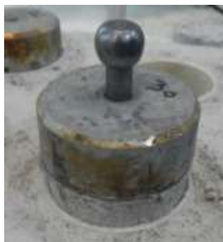
Figura 4: Ensaio de resistência de aderência realizado com a metodologia nova.
