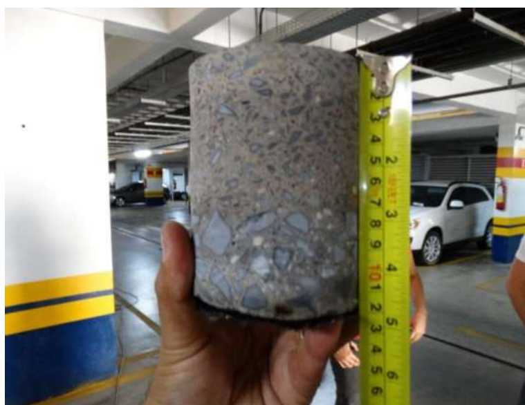
Figura 18 - Testemunho de área sem som cavo.
