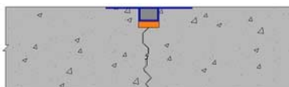
Figura 6 – Tratamento de junta de concretagem e fissura de retração na laje.
