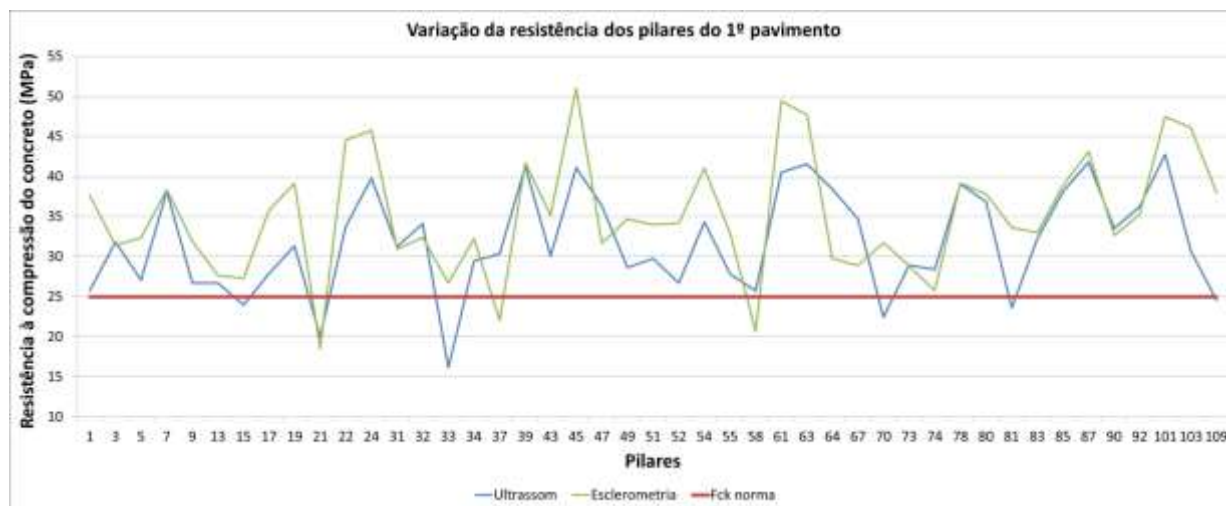
Figura 67: Variação e análise da conformidade da resistência à compressão do concreto segundo os ensaios de ultrassom e esclerometria, para os pilares do primeiro pavimento.
