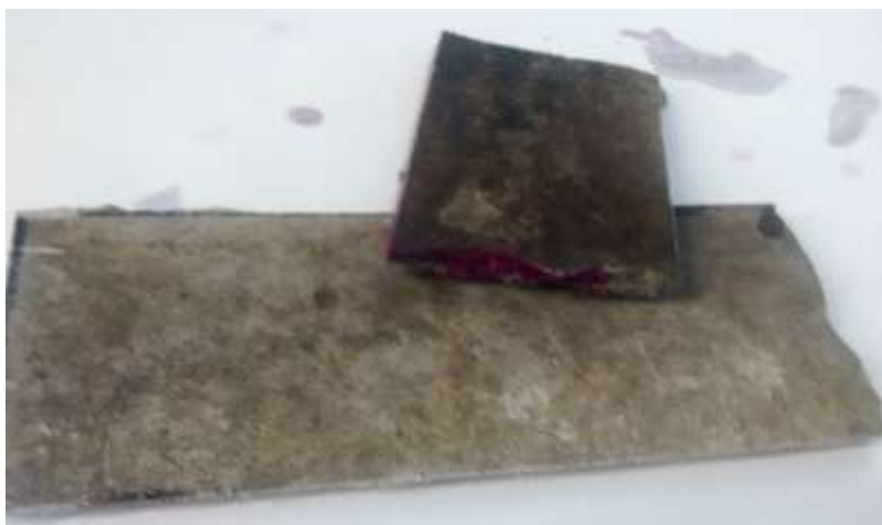
Figura 4: Identificação visual da presença de fungos.
