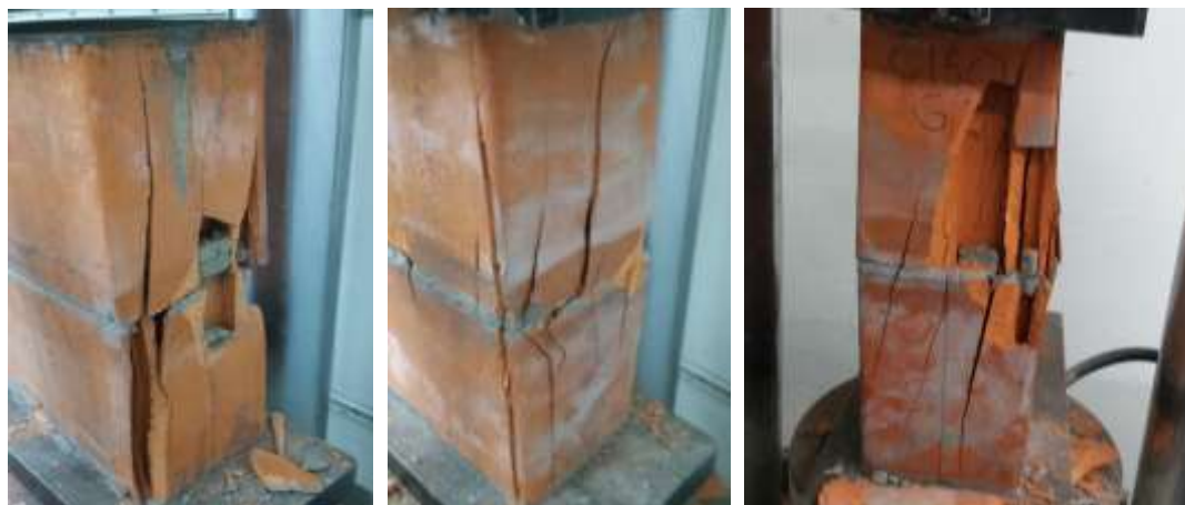
Figura 7: Ruptura de prismas. (a) Argamassa A50. (b) Argamassa B100. (c) Argamassa C150
