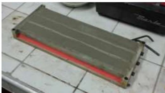
Figura 7 - Moldagem dos corpos-de-prova.
