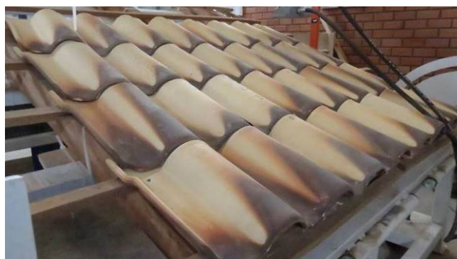
Figura 3 – Amostra do Sistema de cobertura
