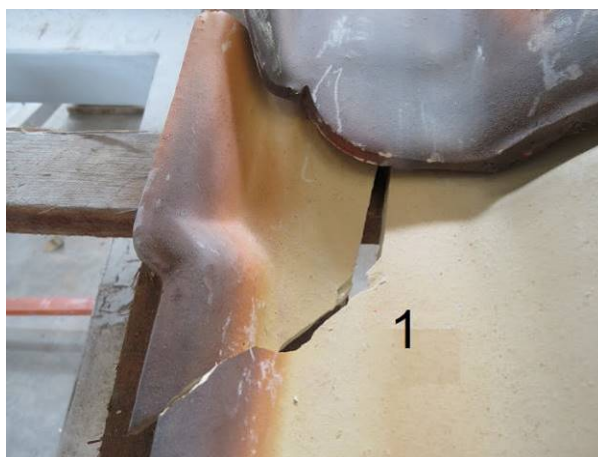
Figura 8 – Falha no ponto 1 com energia de 2,5J
