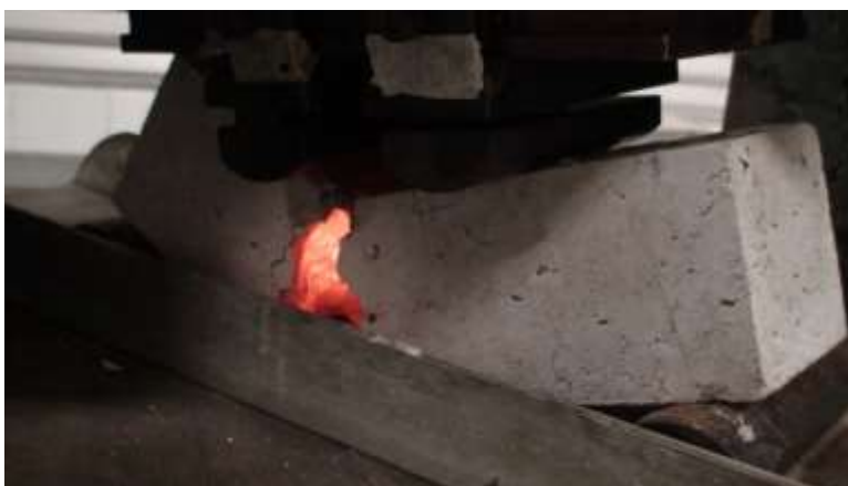
Figura 9: Aspecto dos corpos de prova de concreto após o ensaio de flexão para a temperatura de 900 °C.
