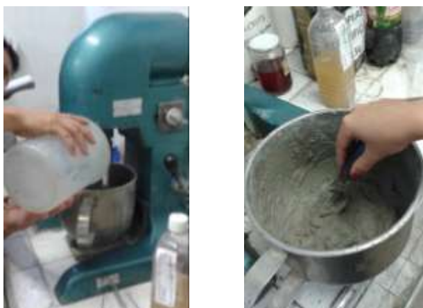
Figura 5 - Mistura da argamassa.
