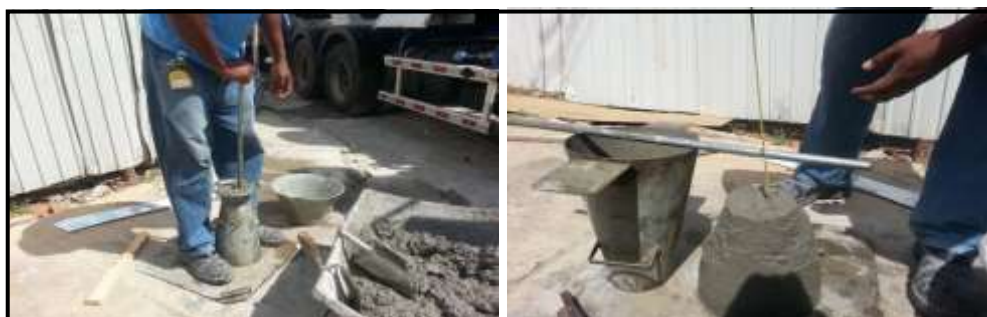
Figura 5: Ensaio do abatimento do tronco do cone ( slump test ).
