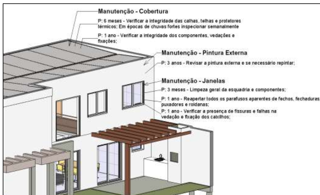
Figura 7: Demonstração da Identificação em Vista Tridimensional das Informações de Manutenção para os Sistemas de Paredes, Esquadrias, Vidros e Cobertura.
