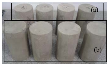
Figura 2: Aspecto visual dos corpos-de-prova com aplicação de produto impermeabilizante como tratamento superficial. (a) corpos-de-prova após processo de lixamento; (b) corpos-de-prova com aplicação do impermeabilizante por cristalização como tratamento superficial
