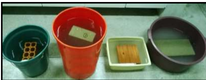
Figura 3: Blocos Submersos nas soluções de NaCl e Cloreto de Cálcio
