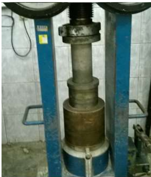
Figura 5: Ensaio de compressão axial.
