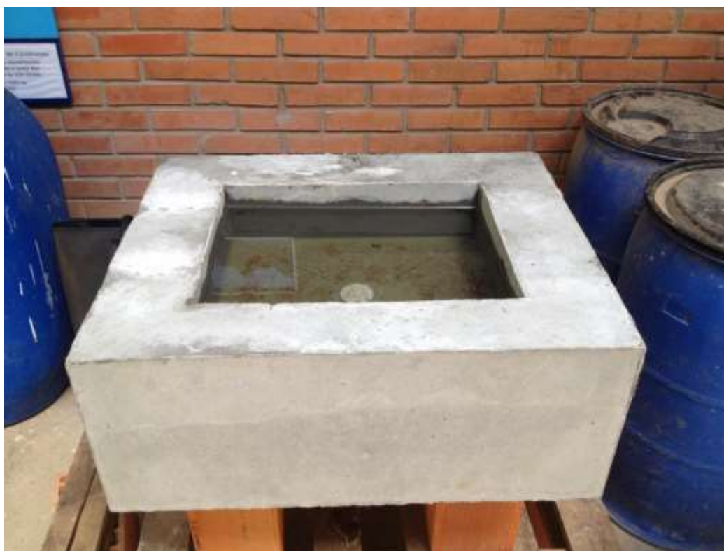
Figura 8: Cuba cheia de água durante o teste de impermeabilidade.
