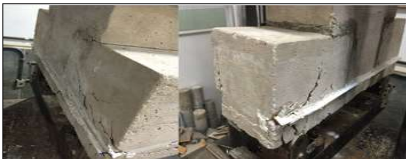
Figura 9: Rompimento do primeiro modelo reforçado
