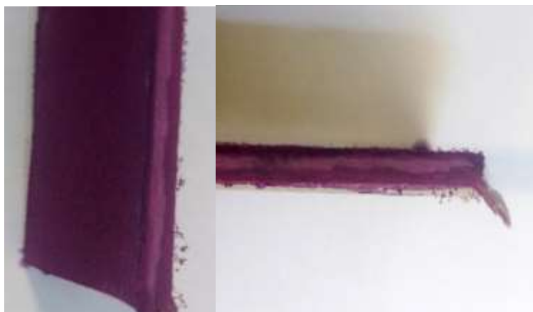
Figura 2: Amostra de telha nova não carbonatada
