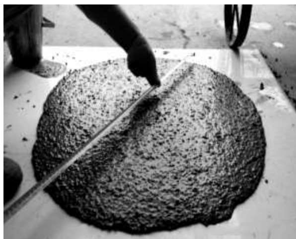
Figura 2 - Ensaio de espalhamento dosagem 3
