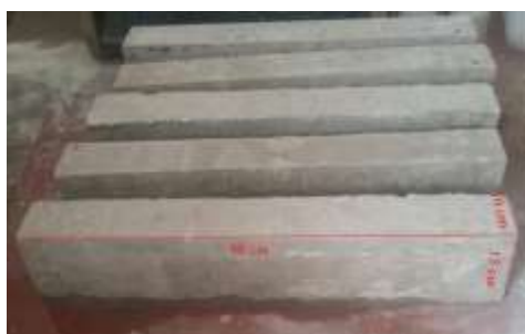
Figura 3: Foto da Viga Concretada com as Dimensões Finais
