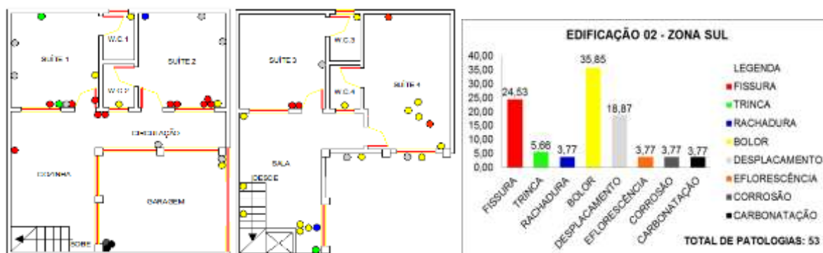
Figura 4: Mapeamento e incidência das patologias dos pavimentos térreo e superior respectivamente da Edificação 2
