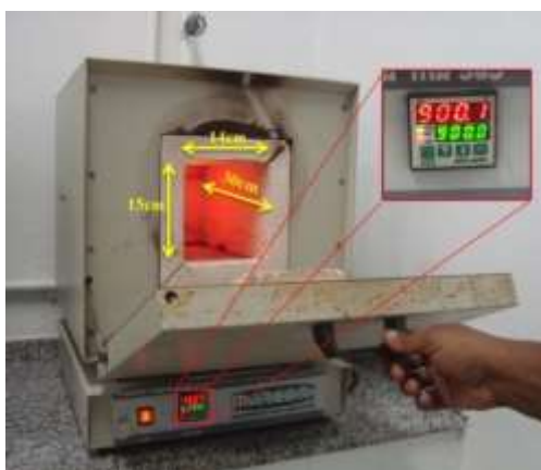
Figura 1: Forno tipo mufla utilizado para a elevação da temperatura do concreto
