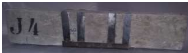
Figura 21: Viga J4 após Aplicação de Reforço
