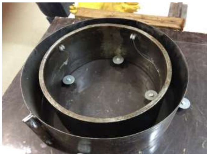
Figura 1: Sistema utilizado nos ensaios de retração, tendo concluída a etapa de posicionamento das fôrmas metálicas interna e externa, assim como a instalação dos extensômetros na face interna do núcleo
