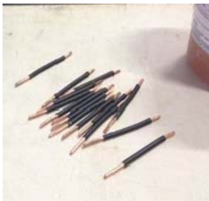
Figura 2: Fios de cobre pronto para serem fixados nos corpos de prova.
