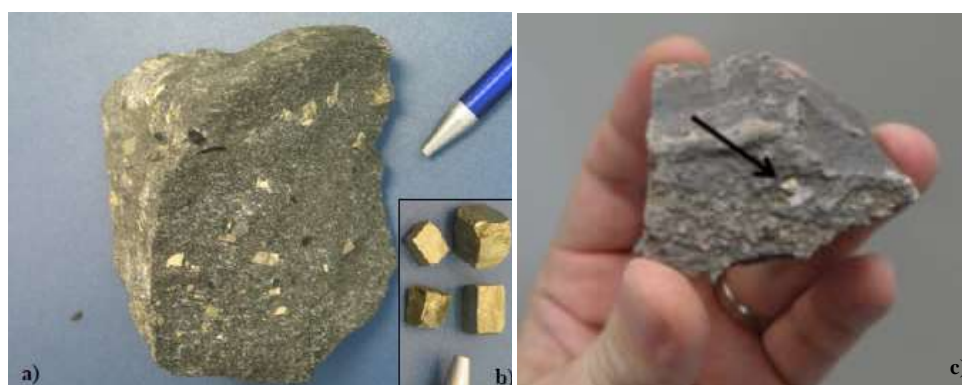
Figura 1 – Maciço rochoso contendo sulfetos na forma de pirita (detalhe a e b) [7]. Agregado de pedra da região próxima ao rio Tibagi no Paraná (detalhe c) [8].
