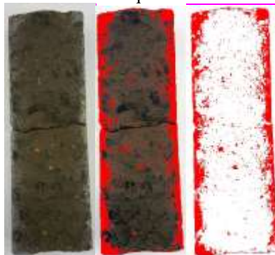
Figura 4: Fotografias das amostras com identificação de tonalidade pelo software
