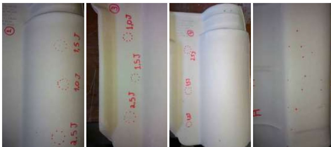
Figura 6 – Imagens das amostras com marcas indicando os impactos e fissuras
