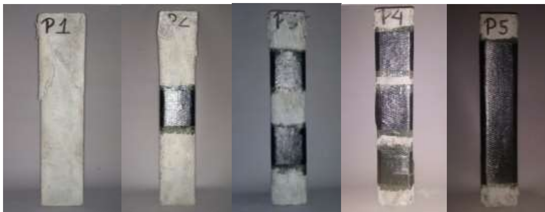
Figura 9: Pilares após a ruptura
