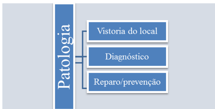
Figura 2: Etapas para identificação da tipologia e solução das patologias
