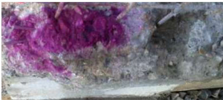
Figura - 1 Profundidade de carbonatação (base de concreto)
