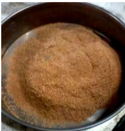
Figura 2: Amostra do pó de Cedrela odorata passante na peneira #16 ABNT (Fonte: Própria, 2015.)
