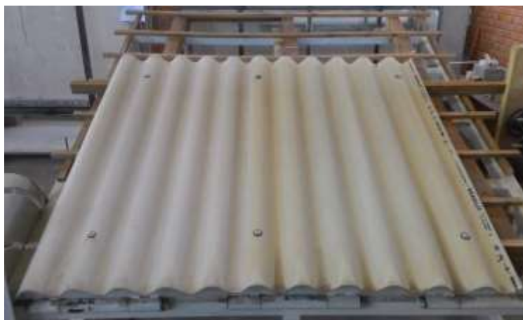
Figura 3 – Sistema de cobertura com telha de fibrocimento pronta para ensaio
