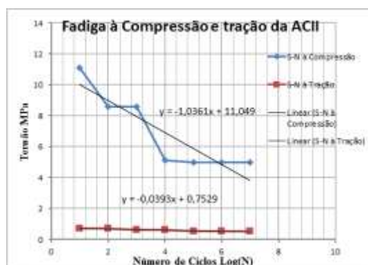
Figura 41: Curvas S-N de Fadiga à Compressão e à Tração Linearizadas para ACII
