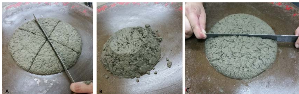
Figura 5: Ensaio de consistência inicial com e sem PSAR. a) Argamassa com PSAR; b) Argamassa referência, sem a adição de PSAR; c) Ajuste de consistência da argamassa referência com relação à consistência encontrada com a incorporação do PSAR.
