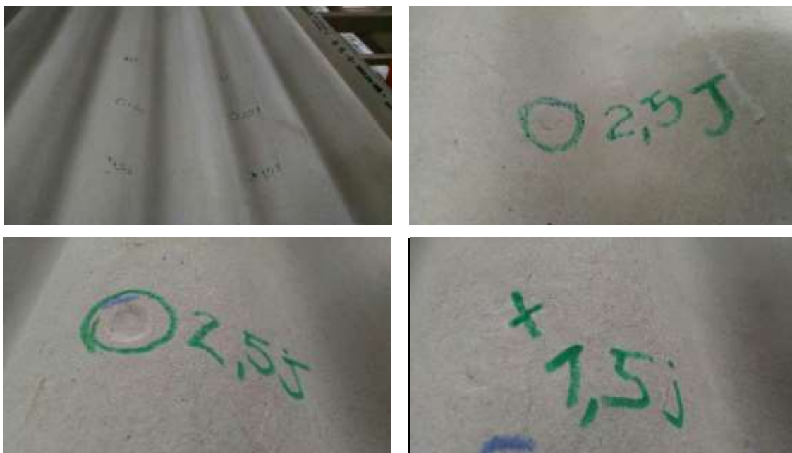
Figura 7 – Imagens das amostras com marcas indicando os impactos.
