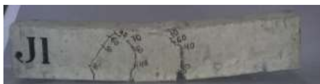
Figura 7: Viga J1 após Ruptura
