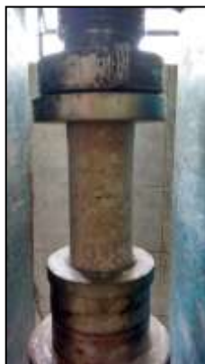
Figura 5: Ensaio de compressão axial dos corpos de prova
