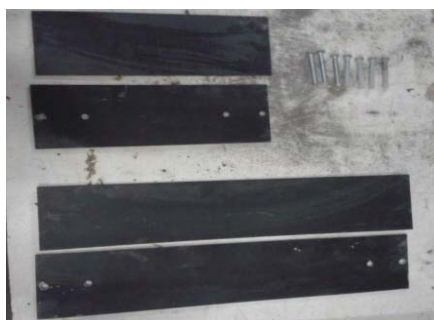
Figura 1 - Chapas de aço e os parafusos utilizados no reforço.
