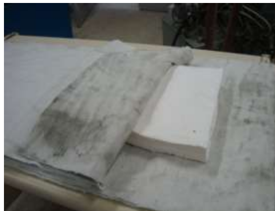
(b) colchão térmico de uma espuma cerâmica
