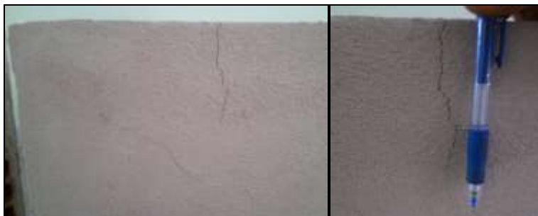
Figura 23: Retração por secagem no modelo revestido pela argamassa com filito
