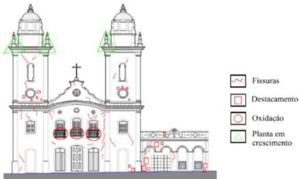
Figura 10: Mapeamento dos danos da fachada principal da Igreja do Menino Deus.
