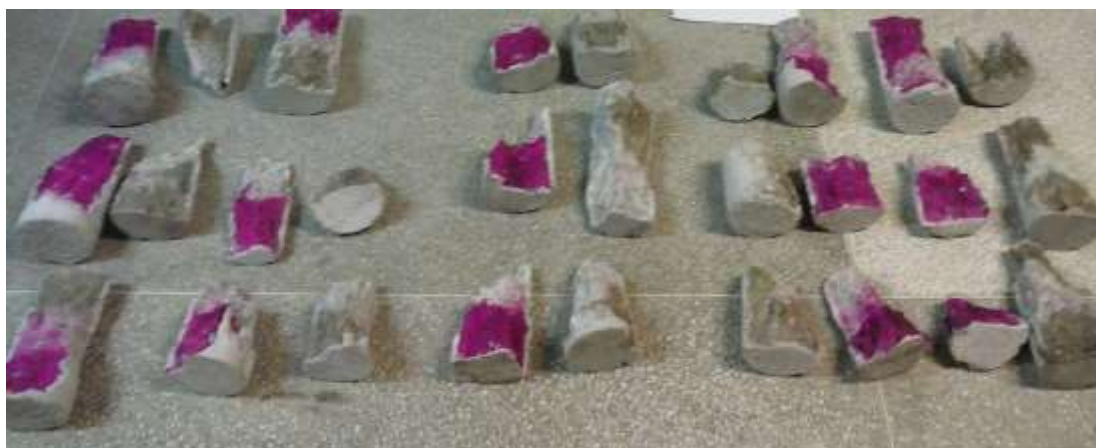
Figura 4 - Corpos-de-prova com tempo de exposição de 16 meses, após ensaio. Fonte: autora
