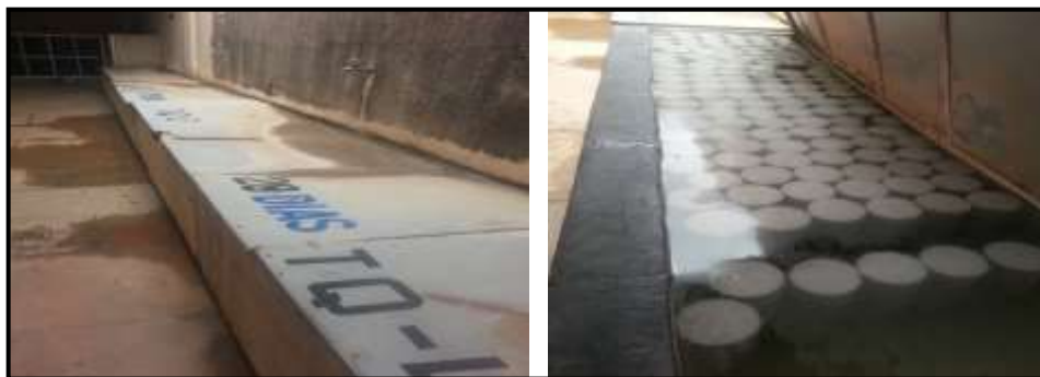
Figura 7: Armazenamento das amostras de concreto na câmara úmida
