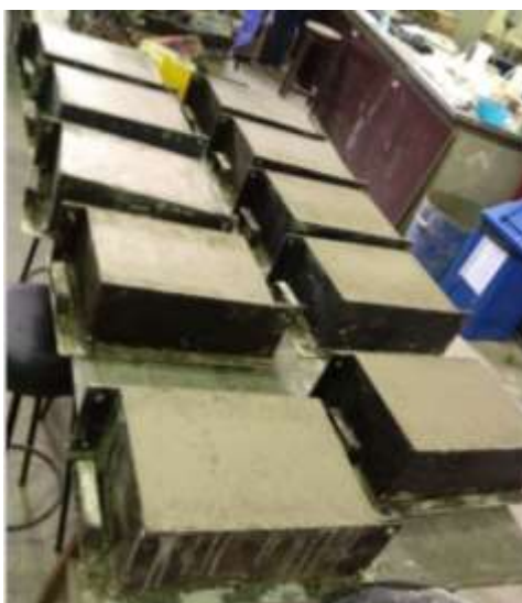
Figura 3: Aplicação da argamassa – Fonte: dos autores
