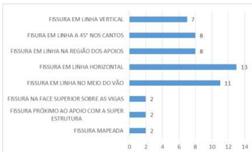
Figura 4 - Tipo e quantidade de fissuras
