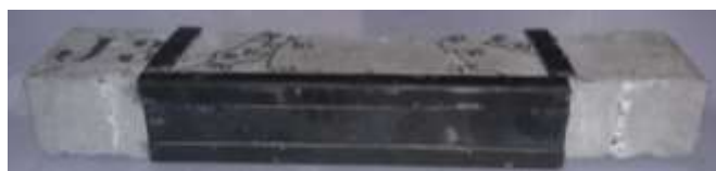
Figura 18: Face Inferior da Viga J3 após Ruptura
