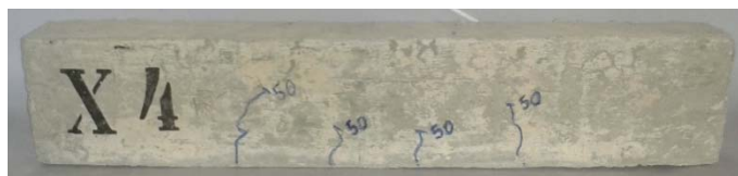
Figura 8 – Viga X4 pré-fissurada.
