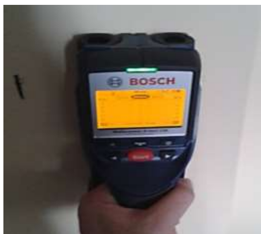
Figura 11: Ensaio de escaneamento das armaduras
