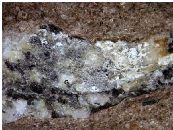
Figura 14 - Aspecto de detalhe da amostra do dolfim 3 no qual se observa uma borda de reação ao redor do agregado graúdo (G) associada a deposição de material branco na superfície de quebra. Microscópio Estereoscópico - ampliação 12x [1]
