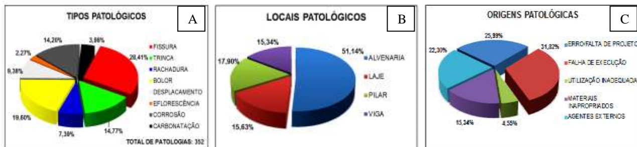
Figura 9: Tabulação das manifestações patológicas averiguadas nas edificações residenciais: (A) incidência dos tipos patológicos; (B) ocorrência dos locais patológicos; (C) possíveis origens das patologias
