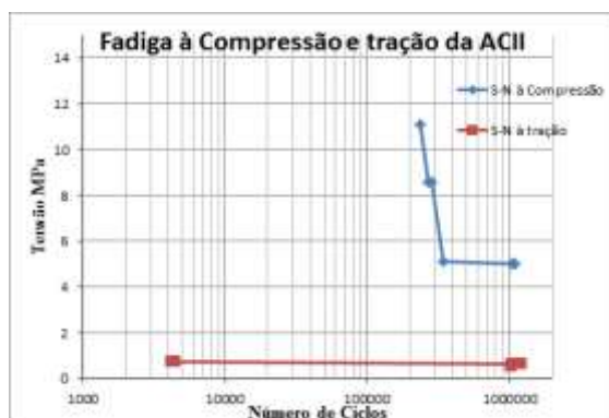
Figura 40: Curvas S-N de Fadiga à Compressão e à Tração da ACII
