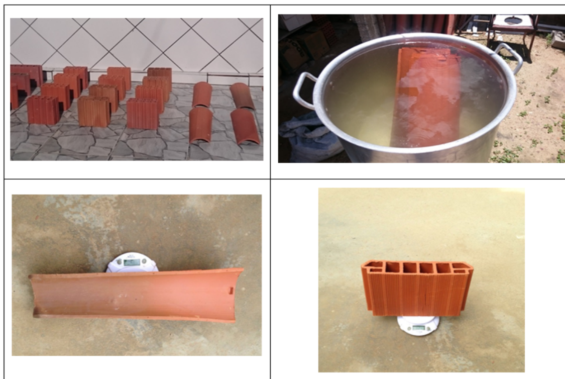
Figura 2: Etapas do ensaio de absorção de água
