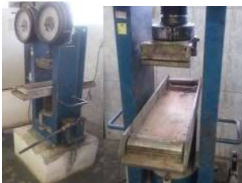
Figura 1: Prensa Hidráulica Universal Adaptada para o Ensaio de Stuttgart e Adaptadores Utilizados
