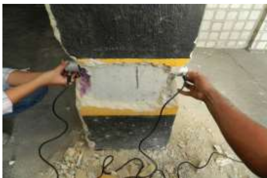
Figura 6 – Realização do ensaio de ultrassom com transmissão direta
