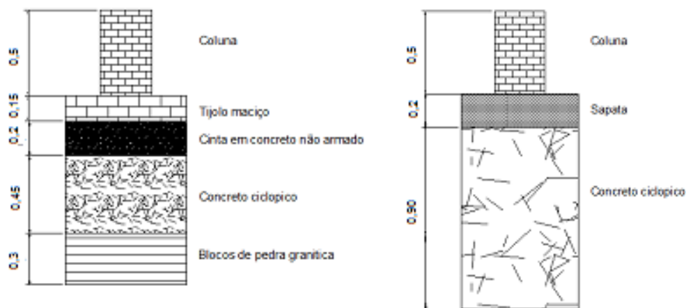
Figura 6: Definição das aluras dos componentes constituintes das fundações da rotunda (Fonte: Multitech, 2013).
