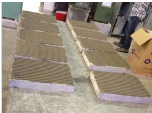
Figura 2: Aplicação do chapisco industrializado – Fonte: dos autores
