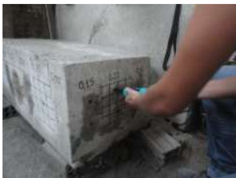
Figura 2: Ensaio de esclerometria.
