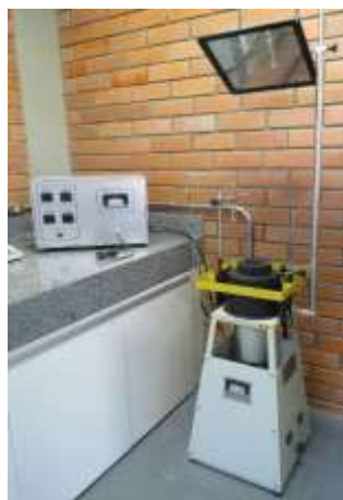
Figura 06 – (a) equipamento: forno ISO 1182; (b) Localização dos termopares na amostra
