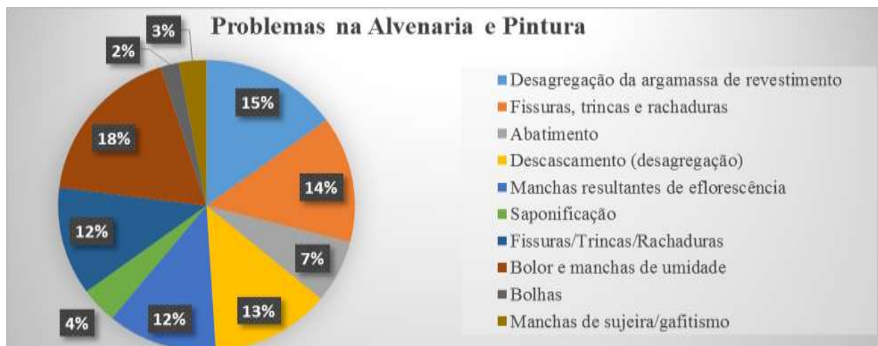
Figura 33: Gráfico apresentando os principais problemas que ocorrem na alvenaria e pintura do prédio objeto de estudo
