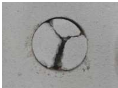
Figura 2: Corpo de prova danificado pelo processo de delimitação da área de ensaio, com uso de serra-copo diamantada.
