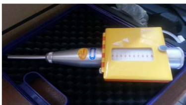
Figura 5: Esclerômetro de Schmidt utilizado.
