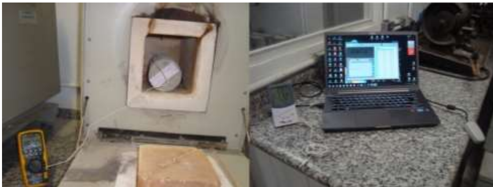
Figura 2: Sistema de aquisição de dados da temperatura no interior dos corpos-de-prova de concreto
