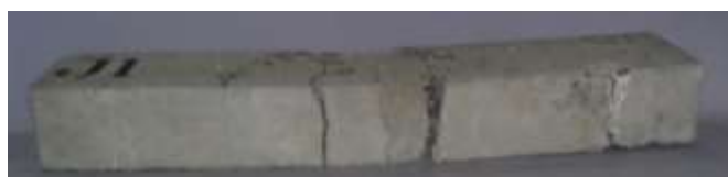
Figura 8: Face Inferior da Viga J1 após Ruptura
