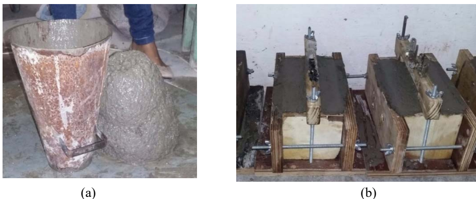
Figura 6: (a) Ensaio de consistência do concreto; (b) Corpos-de-prova prismáticos moldados.
