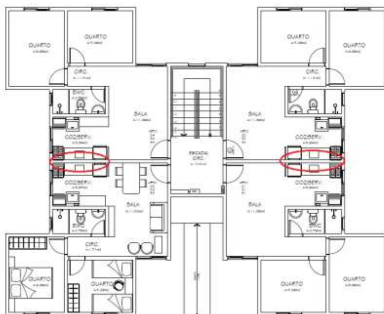
Figura 3: Planta baixa pavimento tipo – “Parede crítica 1”
