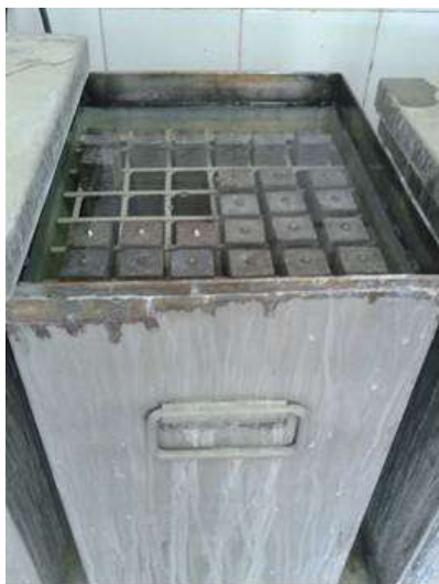
Figura 13 - Condicionamento das amostras em tanque de imersão.
