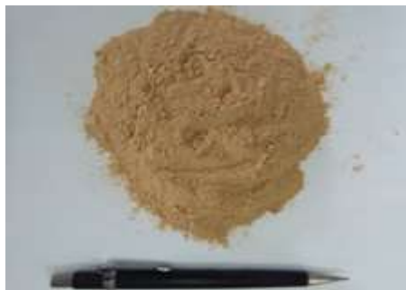
Figura 1: Adição mineral riolito após beneficiamento.
