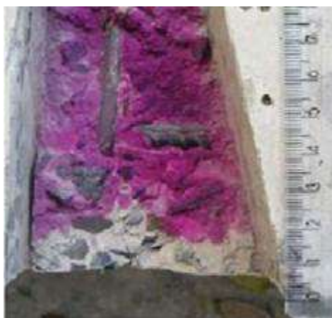
Figura 1: Aplicação do indicador fenolftaleína
