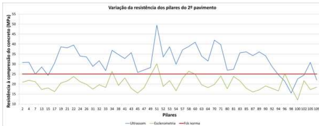
Figura 6: Variação e análise da conformidade da resistência à compressão do concreto segundo os ensaios de ultrassom e esclerometria, para os pilares do segundo pavimento.
