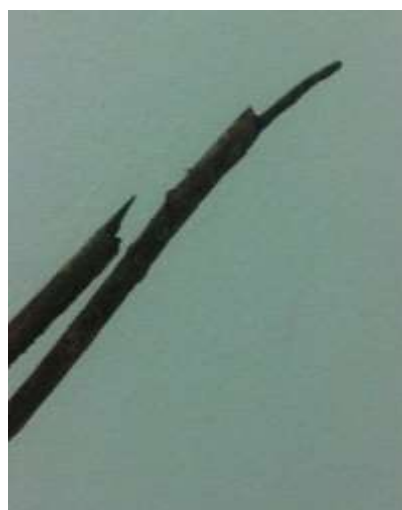
Grau 2 com rompimento por SCC (exumação em estrada)
