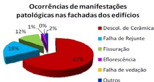
Figura 4 - Ocorrência de manifestações patológicas gerais nas fachadas dos edifícios [17].
