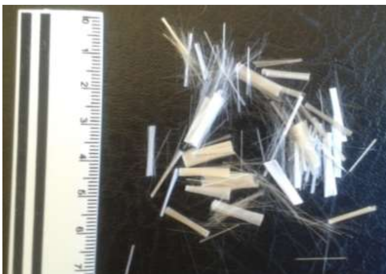
Figura 3 - Fibras de vidro AR 12
