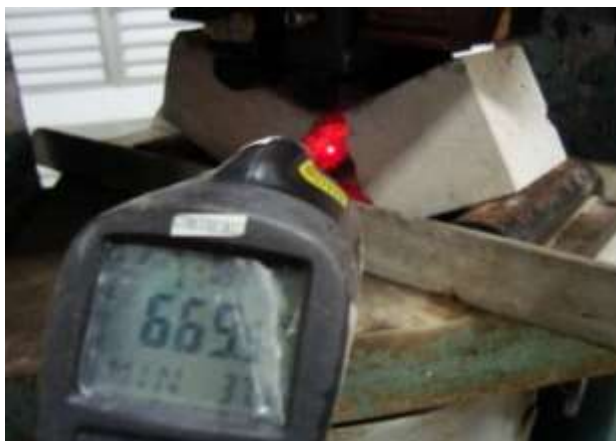
Figura 7: Medição feita no concreto por meio de um termômetro infravermelho
