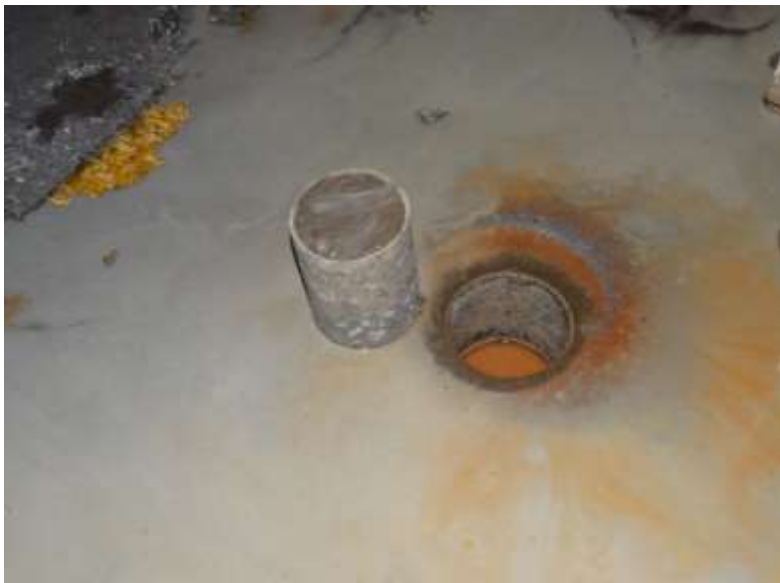
Figura 13 - Testemunho de áreas sem som cavo.
