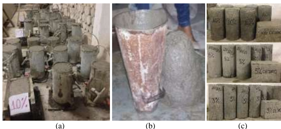
Figura 3: (a) Corpos de prova cilíndricos e prismáticos adensados manualmente; (b) Ensaio de consistência do concreto; e (c) Corpos de prova cilíndricos e prismáticos desmoldados e identificados de acordo com a porcentagem da adição. (Fonte: Própria, 2015.)
