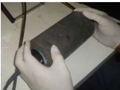
Figura 4 – Leitura da velocidade ultrassônica no corpo de prova
