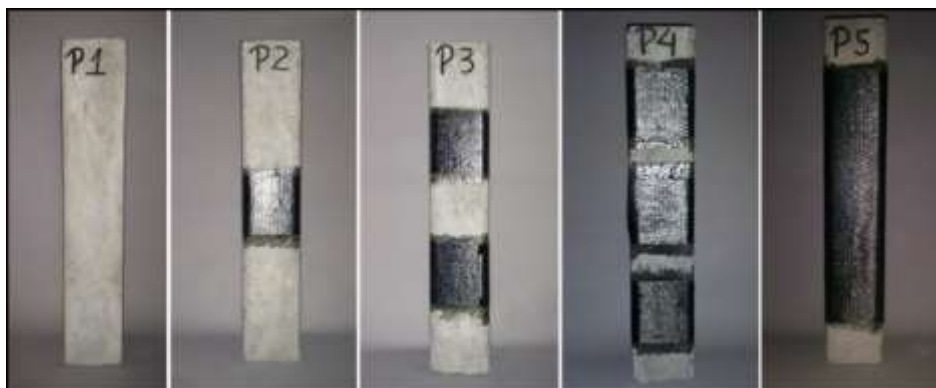
Figura 4: Pilares ensaiados, sendo 1 de referência e 4 reforçados
