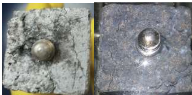
Figura 5 – Aspecto dos corpos de prova contendo CCA, após o ensaio acelerado.
