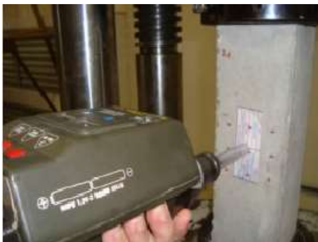
Figura 8: Execução do ensaio de esclerometria
