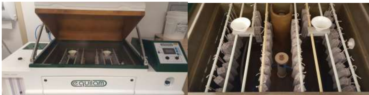
Figura 2: Câmara cíclica para o ensaio de névoa salina e disposição dos corpos de prova
