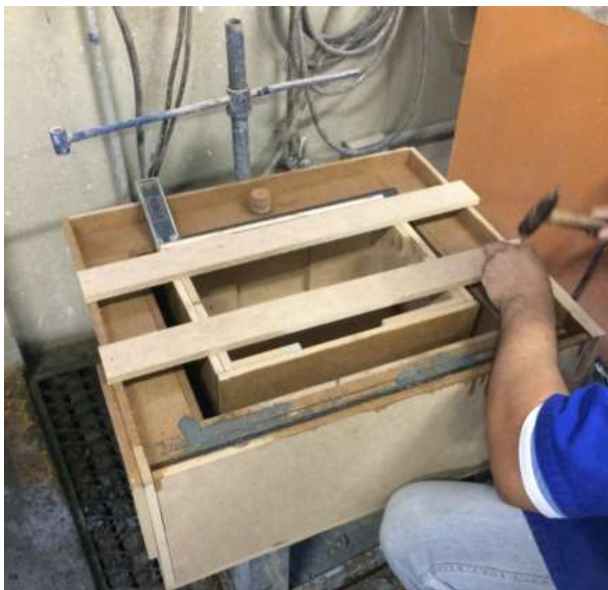
Figura 4: Forma dentro da forma para segunda parte da concretagem.
